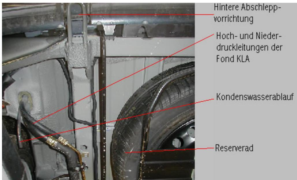
Wie auf diesem Bild deutlich zu Erkennen ist, werden zu der Fond KLA nur die Hoch- und Niederdruckleitungen für das Kättemittel verlegt.
