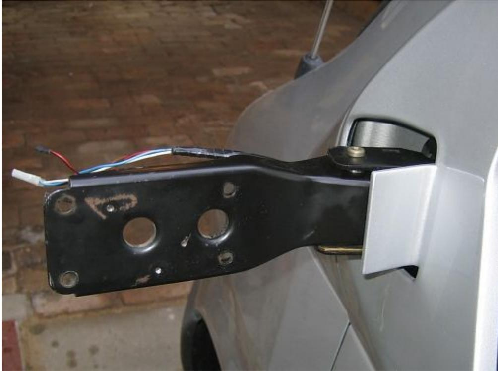
oder man hat nicht so viel Glück und das Kabel einschließlich Stecker läuft durch die Löcher im Metallarm. (Bild 7)
