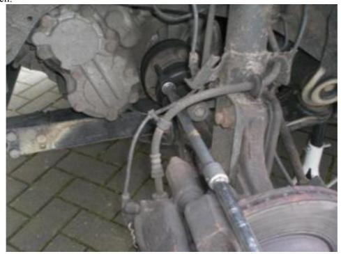
Durch das Drehmoment beim Lösen entwickelt die Welle die Tendenz, sich ebenfalls zu drehen, daher ist hier verklemmen angesagt. Am einfachsten geht das mit den Radbolzen und einer Brechstange wie im Bild unten.
