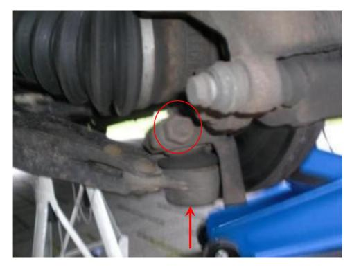
Eine Variante, um Platz für den Ausbau zu schaffen, die auch erprobt ist, ist, diesen Bolzen zu lösen und den Zapfen (Pfeil) nach oben auszutreiben. Vielen Dank an Willy V220, der mir Telefonsupport geleistet hat! Denn: das Federbein auszubauen, was sonst auch eine Variante wäre, ist beim Vau ne dumme Idee...Danach müsste man los und die Spur einstellen lassen.
