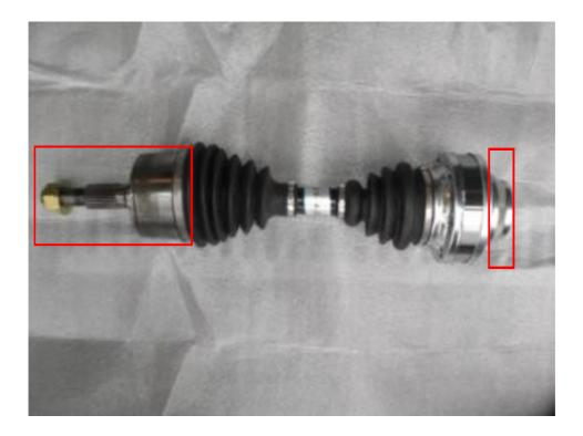
Die rot gerahmten Teilstücke müssen beim Ausbau platzmäßig irgendwo untergebracht werden, und genau da sitzt das Problem...
